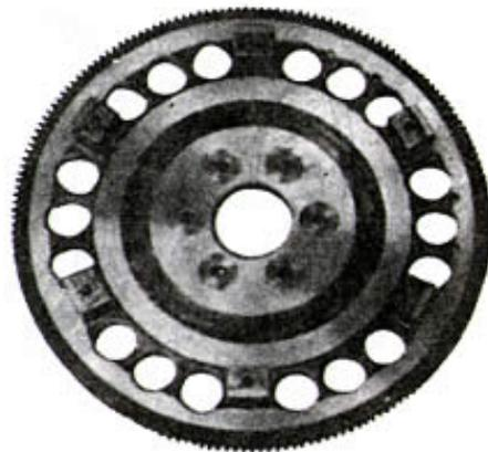
*Volante para motor de alta velocidad, fuertemente alivianado por torneado de la llanta y la producción de agujeros en el plato.*
